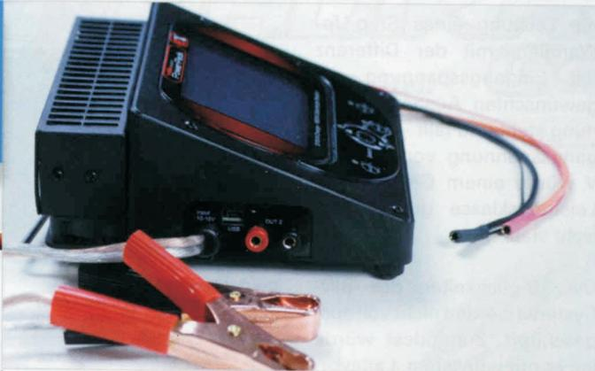
Auf der linken Gehäuseseite befinden sich der Ladeausgang Out 2 und die Mini-USB-Buchse. Zum Anschluss an die Gleichstromquelle dienen massive Polklemmen.
